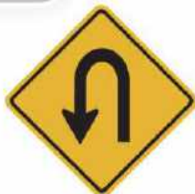
ป้ายเตือน จุดกลับรถซ้าย Left U-turn ahead
