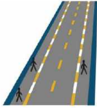
เครื่องหมายเส้นห้ามจอด เว้นแต่หยุดรับ-ส่งชั่วคราว Parking prohibited except temporary loading and unloading เส้นสีขาวสลับเหลือง ห้ามจอดรถทุกชนิด เว้นแต่หยุดรับ-ส่งคน หรือสิ่งของชั่วคราว
