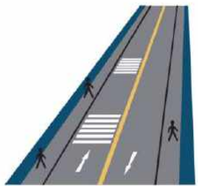
เส้นชะลอความเร็ว Rumble strips มีลักษณะเป็นเส้นหลายๆ เส้น ขวางช่องเดินรถหรือช่องจราจร ให้ขับรถช้าลงและเพิ่มความระมัดระวัง
