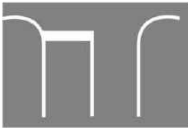
เส้นแนวหยุด Stop line เส้นขวางถนนเป็นเส้นทึบสีขาว ให้หยุดรถก่อนถึงแนวขวางทุกครั้ง
